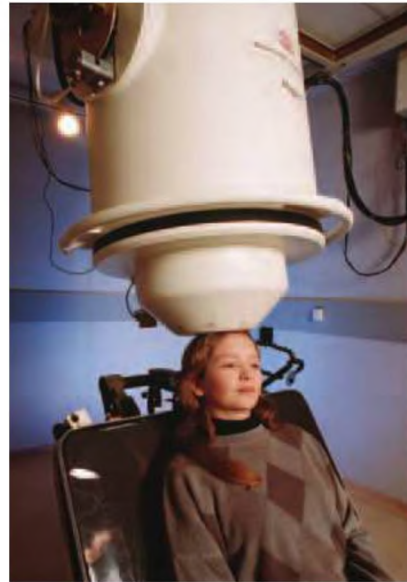
FIGURA 5.24 Magnetoencefalografía Los SQUID de este neuromagnetómetro detectan variaciones regionales en los campos magnéticos producidos por la actividad eléctrica del encéfalo.
